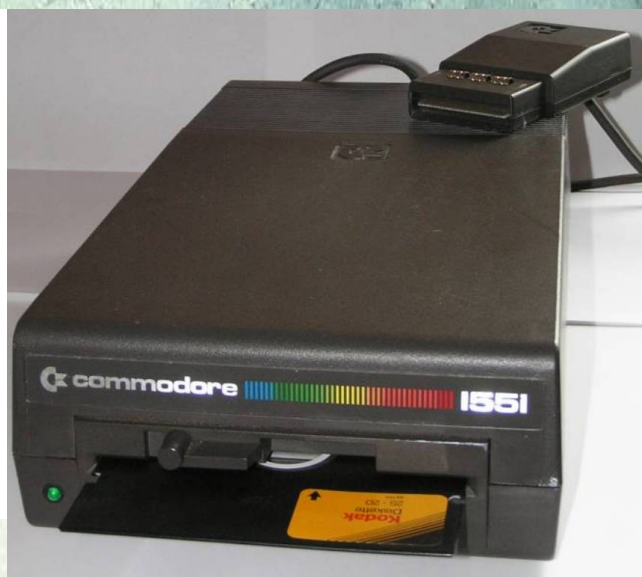
Ed ecco invece il lettore di dischi 1551, più veloce del classico 1541, ma utilizzabile solo sui modelli 264. Un'interfaccia per utilizzarlo con il C64 venne prevista ma non venne mai rilasciata.
