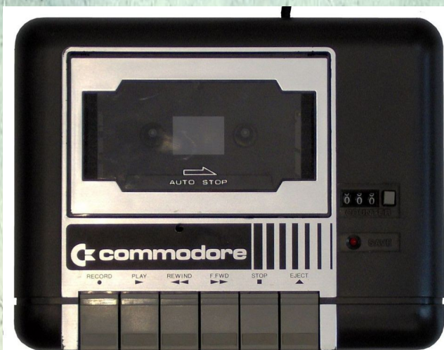
il datassette modello 1531, pensato proprio per la serie 264. L'attacco diverso del cavo lo rendeva incompatibile con gli alti modelli Commodore (C=64 e Vic-20)
