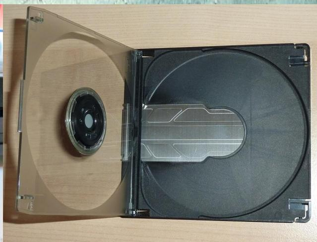
Ecco la risposta: il CD si metteva in questo contenitore che, poi, a sua volta, veniva inserito all'interno del lettore. Il suo funzionamento era esattamente identico a quello di un floppy: dentro il computer la lamina di metallo si apriva e il laser leggeva la superficie del disco.
